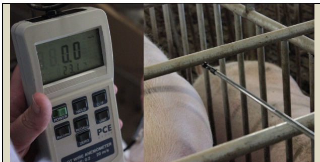
Figuur 7: anemometer op basis van hittedraad
