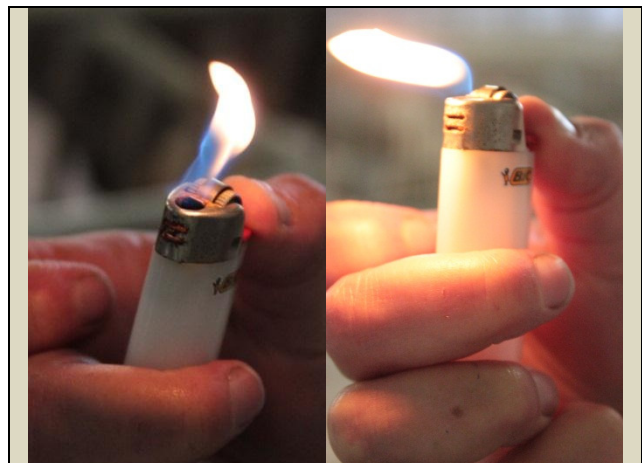
Figuur 6: aansteker om luchtstromen zichtbaar te maken
