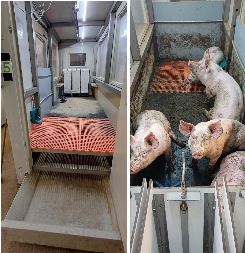
Figuur 1. Opstelling van een gecontroleerde open-circuit gasuitwisselingskamer op ILVO, uitgerust voor vleesvarkens.
