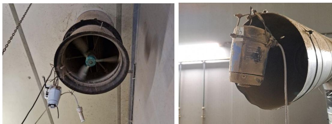
Figuur 4. Opstelling voor emissiebepaling via sensoren aan de uitlaat (links) en voor bepaling van het verwijderingsrendement via concentratiemetingen aan de in- en uitlaat van de filter (rechts).
