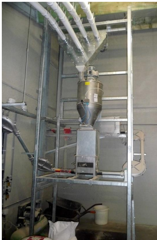
Figuur 12: Computergestuurde voederinstallatie met menger (PVL Bocholt)
