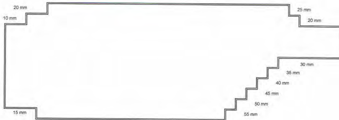
Figuur 11 Voorstelling van een meetlat voor de meting van de rugspedikte
