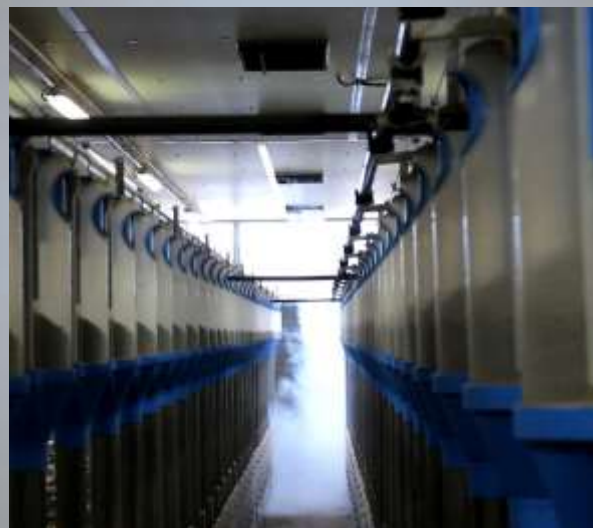
Figuur 9 De rookproef laat een homogene verdeling zien
