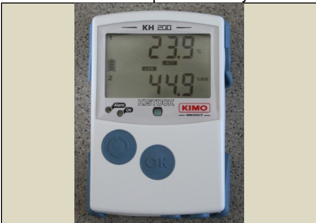
Figuur 2: datalogger voor temperatuur en RV
