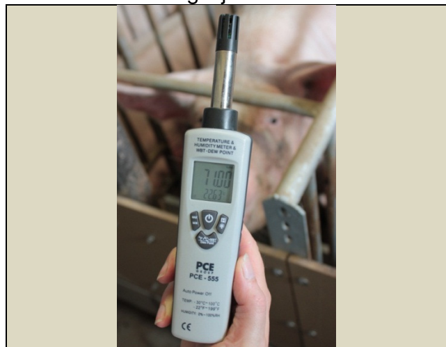
Figuur 3: hygrometer en thermometer combinatie
